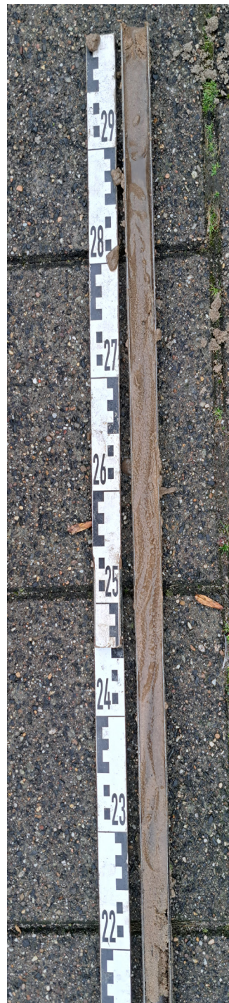
Afbeelding 8. Gutsboor met de inhoud van boring 2 vanaf 2,20 m -mv tot 3,00 m -mv. De bodem bestaat uit in zijn geheel uit (bouw)zand met grind.
