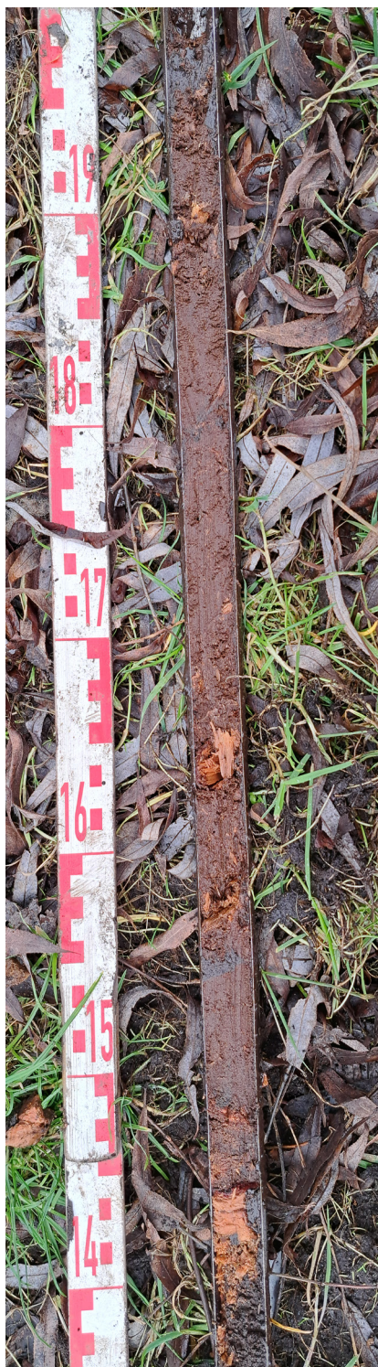
Afbeelding 9. Gutsboor met de inhoud van boring 14 vanaf 1,50 m -mv tot 2,00 m -mv. De bodem bestaat uit een bruinrood veenpakket met fragmenten plantenwortels.
